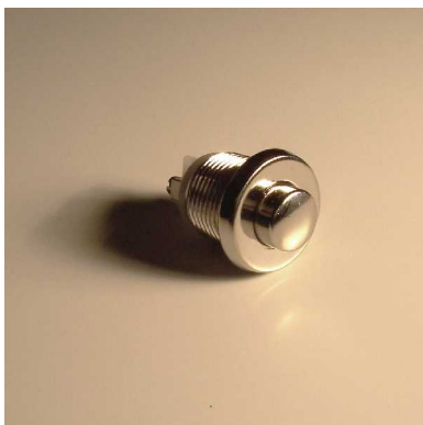
Einschraubkontakt ES148 Aussendurchmesser 20mm Einbaudurchmesser 15mm Plattenstärke 1-5mm Schraubanschlüsse
