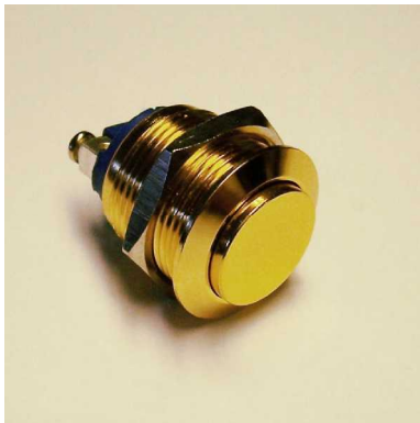
Einschraubkontakt 701274 (-75/-80) Aussendurchmesser 18mm Einbaudurchmesser 16mm Plattenstärke 2-8mm Schraubanschlüsse
