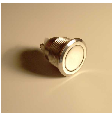
Einschraubkontakt ES155 Aussendurchmesser 22mm Einbaudurchmesser 18mm Plattenstärke 1-5mm Schraubanschlüsse, IP44 (in eingebautem Zustand)
