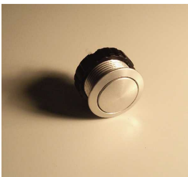
Einschraubkontakt ES152 Aussendurchmesser 21mm Einbaudurchmesser 18mm Plattenstärke 1-5mm Schraubanschlüsse, IP44 (in eingebautem Zustand)
