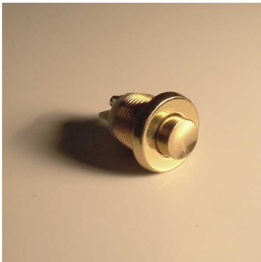
Einschraubkontakt ES145 Aussendurchmesser 20mm Einbaudurchmesser 18mm Plattenstärke 1-5mm Schraubanschlüsse
