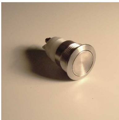
Einschraubkontakt ES153 Aussendurchmesser 21mm Einbaudurchmesser 18mm Plattenstärke 1-5mm Schraubanschlüsse, IP44 (in eingebautem Zustand)
