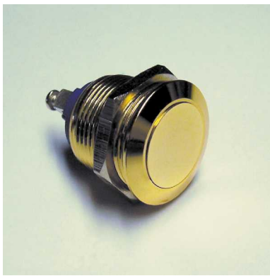
Einschraubkontakt 701268 (-70) Aussendurchmesser 22mm Einbaudurchmesser 19mm Plattenstärke 2-8mm Schraubanschlüsse
