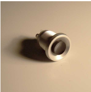
Einschraubkontakt ES1146 Aussendurchmesser 20mm Einbaudurchmesser 16mm Plattenstärke 1-5mm Schraubanschlüsse
