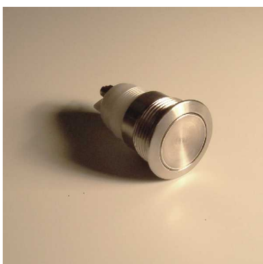
Einschraubkontakt ES253 Aussendurchmesser 21mm Einbaudurchmesser 18mm Plattenstärke 1-5mm Schraubanschlüsse, IP44 (in eingebautem Zustand)
