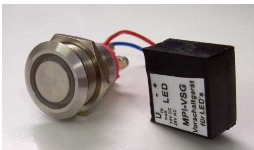
Einschraubkontakt mit LED Ringbeleuchtung Aussendurchmesser 22mm Einbaudurchmesser 19mm Plattenstärke 2-8mm Schraubanschlüsse
