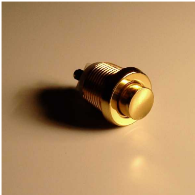
Einschraubkontakt ES142 Aussendurchmesser 18mm Einbaudurchmesser 15mm Plattenstärke 1-5mm Schraubanschlüsse
