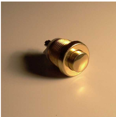
Einschraubkontakt ES142-X Aussendurchmesser 18mm Einbaudurchmesser 16mm Plattenstärke 1-5mm Schraubanschlüsse Drücker bombiert
