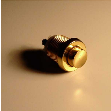
Einschraubkontakt ES140 Aussendurchmesser 18mm Einbaudurchmesser 16mm Plattenstärke 1-5mm Schraubanschlüsse
