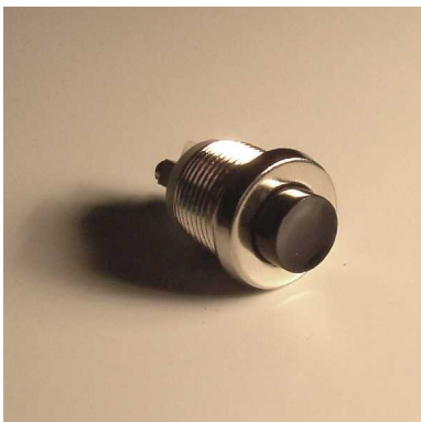
Einschraubkontakt ES140-S Aussendurchmesser 18mm Einbaudurchmesser 16mm Plattenstärke 1-5mm Schraubanschlüsse Drücker Kunststoff schwarz
