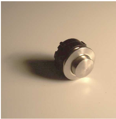
Einschraubkontakt ES144 Aussendurchmesser 20mm Einbaudurchmesser 16mm Plattenstärke 1-5mm Schraubanschlüsse
