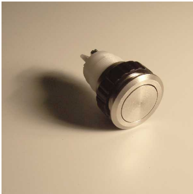
Einschraubkontakt ES258 Aussendurchmesser 22mm Einbaudurchmesser 18mm Plattenstärke 1-5mm Schraubanschlüsse, IP44 (in eingebautem Zustand)
