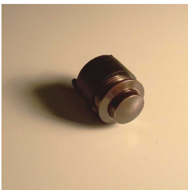
Einschraubkontakt ES143 Aussendurchmesser 17,5mm Einbaudurchmesser 15mm Plattenstärke 1-5mm Schraubanschlüsse
