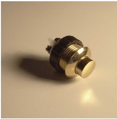
Einschraubkontakt ES141-X Aussendurchmesser 18mm Einbaudurchmesser 16mm Plattenstärke 1-5mm Schraubanschlüsse Drücker bombiert
