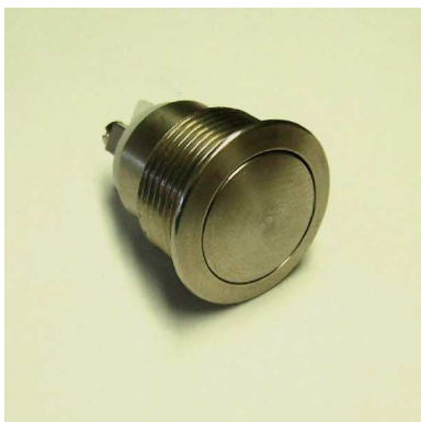
Einschraubkontakt ES252 Aussendurchmesser 21mm Einbaudurchmesser 18mm Plattenstärke 1-5mm Schraubanschlüsse, IP44 (in eingebautem Zustand)
