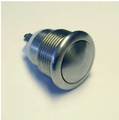
Einschraubkontakt ES260 Aussendurchmesser 21mm Einbaudurchmesser 18mm Plattenstärke 1-5mm Schraubanschlüsse, IP44 (in eingebautem Zustand)
