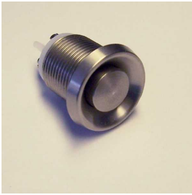
Einschraubkontakt ES1142 Aussendurchmesser 20mm Einbaudurchmesser 15mm Plattenstärke 1-5mm Schraubanschlüsse
