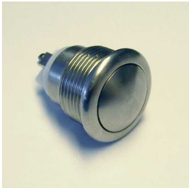
Einschraubkontakt ES160 Aussendurchmesser 21mm Einbaudurchmesser 18mm Plattenstärke 1-5mm Schraubanschlüsse, IP44 (in eingebautem Zustand)
