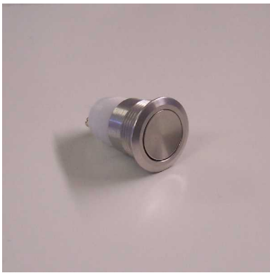
Einschraubkontakt ES255 Aussendurchmesser 22mm Einbaudurchmesser 18mm Plattenstärke 1-5mm Schraubanschlüsse, IP44 (in eingebautem Zustand)
