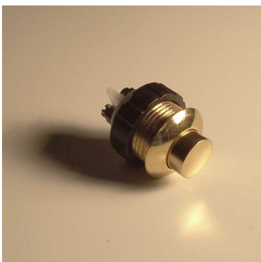
Einschraubkontakt ES141 Aussendurchmesser 18mm Einbaudurchmesser 15mm Plattenstärke 1-5mm Schraubanschlüsse
