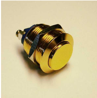
Einschraubkontakt 701284 (-86) Aussendurchmesser 22mm Einbaudurchmesser 19mm Plattenstärke 2-8mm Schraubanschlüsse
