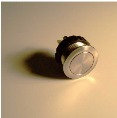
Einschraubkontakt ES158 Aussendurchmesser 22mm Einbaudurchmesser 18mm Plattenstärke 1-5mm Schraubanschlüsse, IP44 (in eingebautem Zustand)
