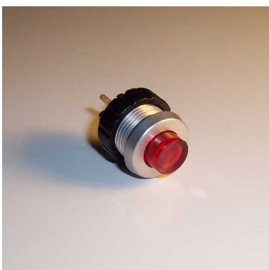
Lichttaster LT142 Aussendurchmesser 18mm, Einbaudurchmesser 15mm Plattenstärke 2-5mm, Schraubanschlüsse Indirekt beleuchtbar
