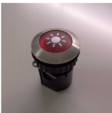
Lichttaster 630 Aussendurchmesser 22mm, Einbaudurchmesser 16mm Plattenstärke 2-5mm, Schraubanschlüsse Mit integrierter LED-Beleuchtung und eingebautem Vorwiderstand
