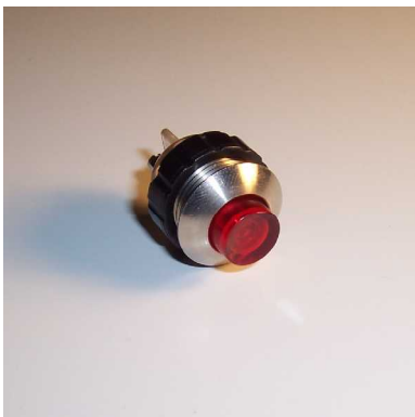
Lichttaster LT141 Aussendurchmesser 18mm, Einbaudurchmesser 15mm Plattenstärke 2-5mm, Schraubanschlüsse Indirekt beleuchtbar
