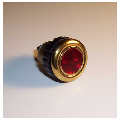
Lichttaster LT160 Aussendurchmesser 21mm, Einbaudurchmesser 18mm Plattenstärke 2-5mm, Schraubanschlüsse Indirekt beleuchtbar In eingebautem Zustand IP44
