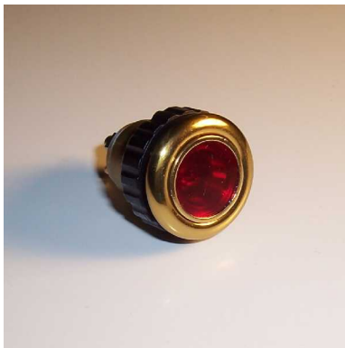
Lichttaster LT260 Aussendurchmesser 22mm, Einbaudurchmesser 18mm Plattenstärke 2-8mm, Schraubanschlüsse Indirekt beleuchtbar In eingebautem Zustand IP66
