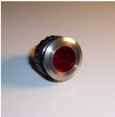
Lichttaster LT158 Aussendurchmesser 22mm, Einbaudurchmesser 18mm Plattenstärke 2-5mm, Schraubanschlüsse Indirekt beleuchtbar In eingebautem Zustand IP44
