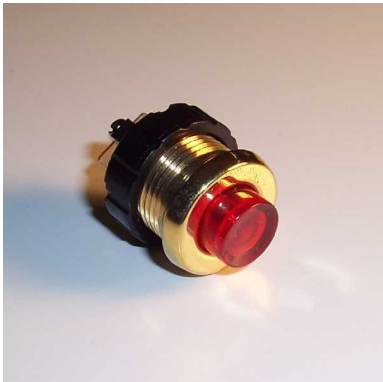
Lichttaster LT140 Aussendurchmesser 18mm, Einbaudurchmesser 16mm Plattenstärke 2-5mm, Schraubanschlüsse Indirekt beleuchtbar
