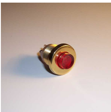
Lichttaster LT145 Aussendurchmesser 20mm, Einbaudurchmesser 18mm Plattenstärke 2-5mm, Schraubanschlüsse Indirekt beleuchtbar
