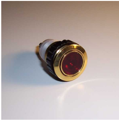
Lichttaster LT252 Aussendurchmesser 21mm, Einbaudurchmesser 18mm Plattenstärke 2-8mm, Schraubanschlüsse Indirekt beleuchtbar In eingebautem Zustand IP66
