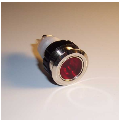
Lichttaster LT258 Aussendurchmesser 22mm, Einbaudurchmesser 18mm Plattenstärke 2-8mm, Schraubanschlüsse Indirekt beleuchtbar In eingebautem Zustand IP66
