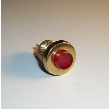
Lichttaster LT148 Aussendurchmesser 20mm, Einbaudurchmesser 15mm Plattenstärke 2-5mm, Schraubanschlüsse Indirekt beleuchtbar
