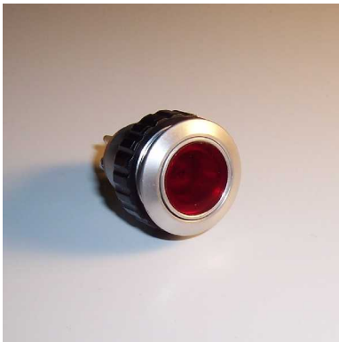
Lichttaster LT152 Aussendurchmesser 21mm, Einbaudurchmesser 18mm Plattenstärke 2-5mm, Schraubanschlüsse Indirekt beleuchtbar In eingebautem Zustand IP44
