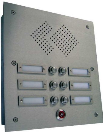
UP-Kontaktplatte Modell 021 Front Edelstahl V2A geschliffen, 2mm stark Edelstahlrähmchen 60 x 20 mm Namensschiebeeinlagen von vorne wechselbar Sprechfeld mit rückseitiger Halterung für Sprechmodul Einschraubkontakte ES140nm, Edelstahl matt Lichttaster 63052, Kragen Edelstahl matt, Drücker rot mit integrierter LED-Beleuchtung (Kleinspannung!)
