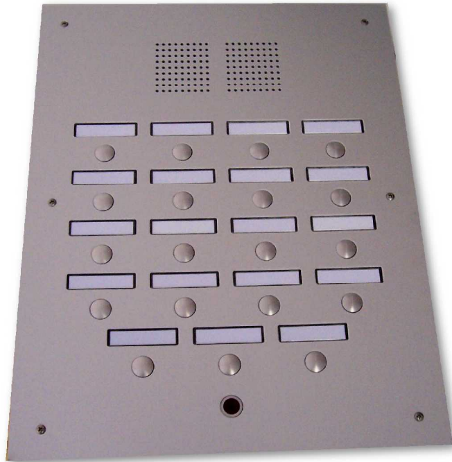
UP-Kontaktplatte Modell 020 Front Edelstahl V2A geschliffen, vandalismusgeschützt, frontbündig Namensschiebeeinlagen von vorne wechselbar Sprechfeld mit rückseitiger Halterung für Sprechmodul Auf Wunsch beleuchtbar mittels LED oder Beleuchtungseinheiten BL1311
