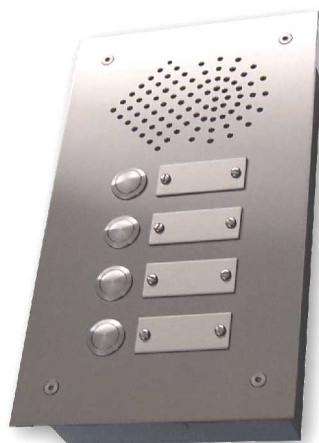
UP-Kontaktplatte Modell 017 Front Edelstahl V2A geschliffen Einschraubkontakte ES152nm, Gehäuse und Drücker Edelstahl matt Gravierschilder 50x20x1mm, Edelstahl matt Sprechfeld L-G44 mit rückseitiger Befestigung für Sprechmodul Ab 6 Tastern 2-reihig.
