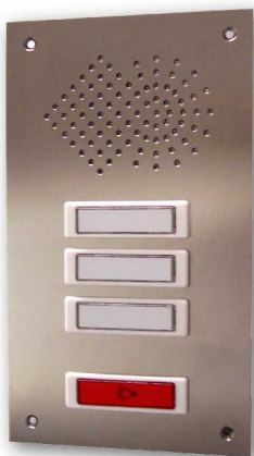
UP-Kontaktplatte Modell 016 Front Edelstahl V2A geschliffen Namensschildtaster NT1331. Gehäuse Kunststoff weiss, Abdeckung glasklar Einlagen von vorne wechselbar Lichttaster (Kleinspannung / indirekt beleuchtbar) Sprechfeld L-G44 mit rückseitiger Befestigung für Sprechmodul Ab 6 Tastern 2-reihig.
