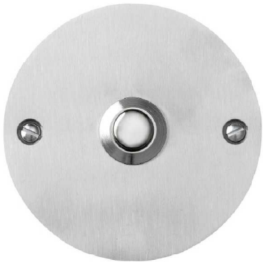
Unterputz-Kontaktplatte D 78 x 2mm, Edelstahl matt Lochabstand 60mm für Montage auf UP-Schalterdose
