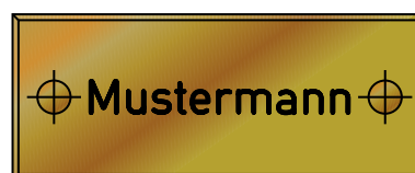
Gravurschrift graviert mit Werkzeug 0,5mm Breite (Simulation)
